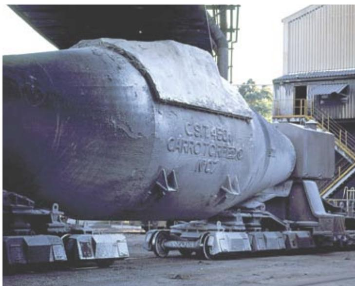
*Carro Torpedo fabricado pela SMS Demag utilizado no transporte de gusa líquido*
