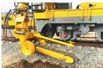
Abertura de Valas
